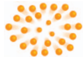
さらに振動と乾燥エアにより一次・二次に近い粒子は凝集体から離れ粒子は軽くなり、乾燥エアによる加圧あるいは出口を減圧することによる差圧などで捕集される
