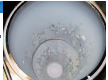
分散した粒子は別置きの捕集タンクへ
